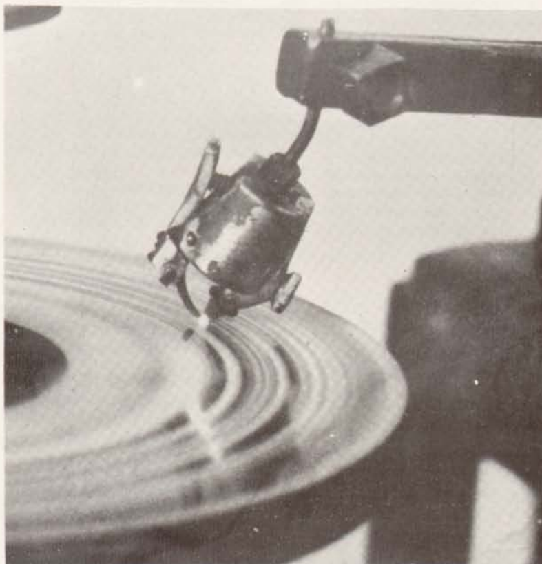
Una scintilla tra la staffa di supporto del diamante e l'utensile per lappare.
