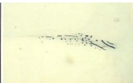
Fig. 4 - Corindone naturale trattato per termodiffusione. ADDENSAMENTI DI COLORAZIONE RESIDUA IN CORRISPONDENZA DI CAVITÀ BEANTI PREESISTENTI AL TRATTAMENTO.
