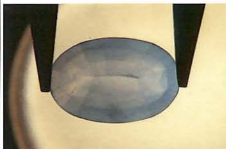
Fig. 2 - Corindone naturale in ioduro di metilene trattato per termodiffusione. SI NOTANO EVIDENTI ADDENSAMENTI DELLA COLORAZIONE IN CORRISPONDENZA DEGLI SPIGOLI. INOLTRE LE FACCE RISULTANO COLORATE CON DIVERSA INTENSITÀ.
