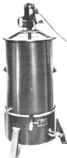
Apparato per il recupero dell'oro dai bagni vecchi o mal riusciti, dando la possibilità di recuperare totalmente l'oro ed altri metalli preziosi esistenti nei bagni, lavoro eseguito con la massima facilità e la minima spesa.
