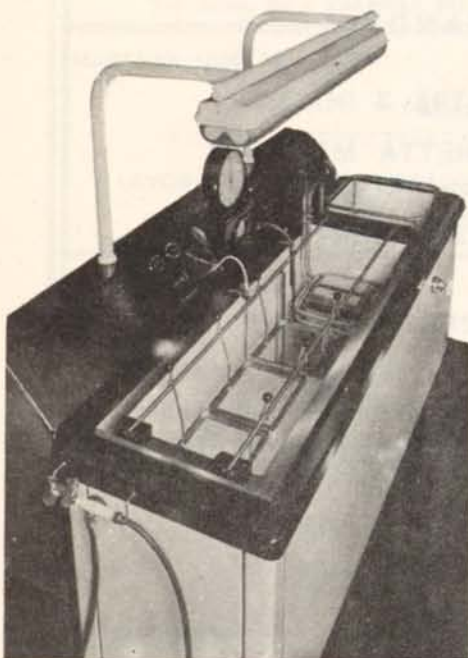
Apparato funzionante con Ultrasuoni per il lavaggio e la pulitura in massa con sostanze Alcaline. Di minuterie metalliche di qualsiasi genere. Celluloide e materiale plastico. In pochi secondi toglie e rende pulito dalle sostanze più insistenti anche nelle profondità.
