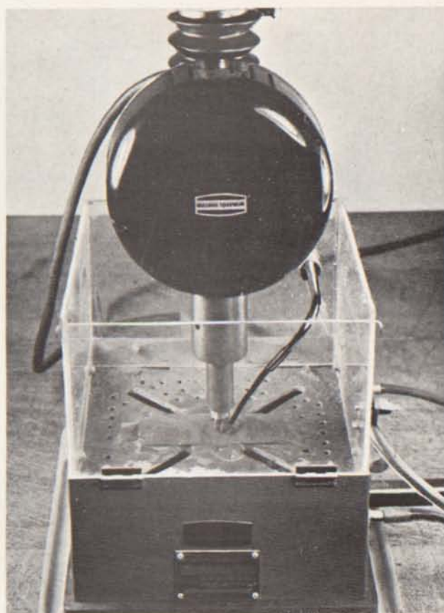
FIG. 6 - Particolare del trapano ad ultrasuoni. E' visibile il trasformatore di velocità.
