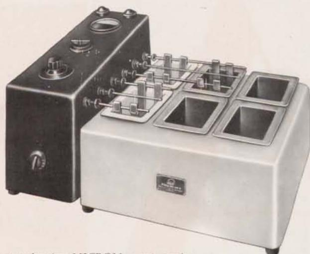
Banco galvanico MICROM a sei vasche per bagni di Doratura e Rodiatura di Gioiellerie, Oreficerie e Bijouterie. E' dotato di tre vasche per bagni galvanici, una vasca di decappaggio e due vasche di risciacquo della capacità di 4 litri ciascuna.
